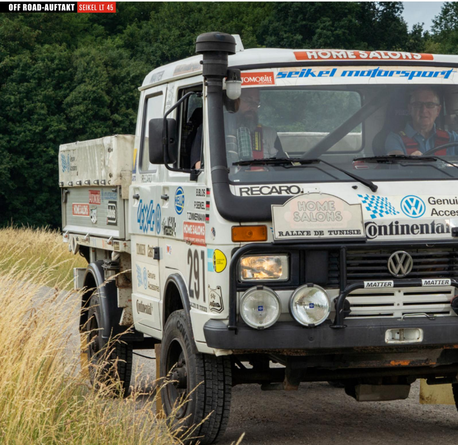
Gelände sorgen, Doppelstoßdämpfer waren schon damals Pflicht. Der Sechsender erstarkte minimal auf 120 PS, während die Fünfgang-Schaltbox nicht angetastet wurde, bevor es Richtung Dakar ging.
